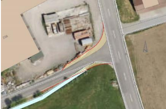
Abbildung 7: Ausweichstelle und Begradigung
